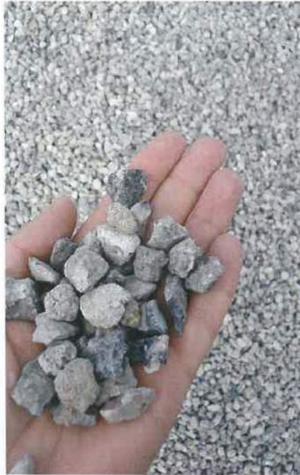
Handlich: Recycling-Beton hat teilweise bessere Verarbeitungseigenschaften als neuer.
